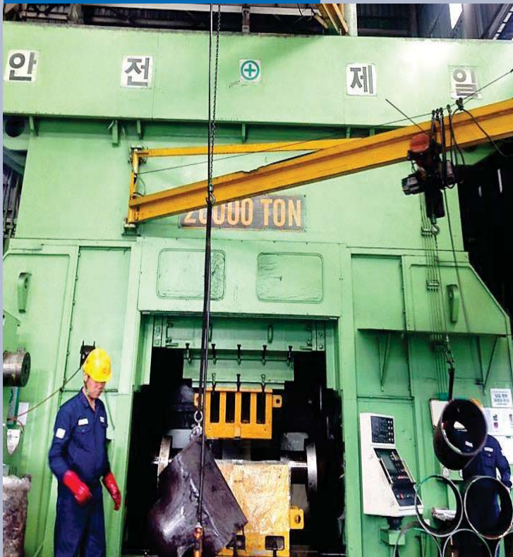
Tee Bulging Press 20,000 Ton
