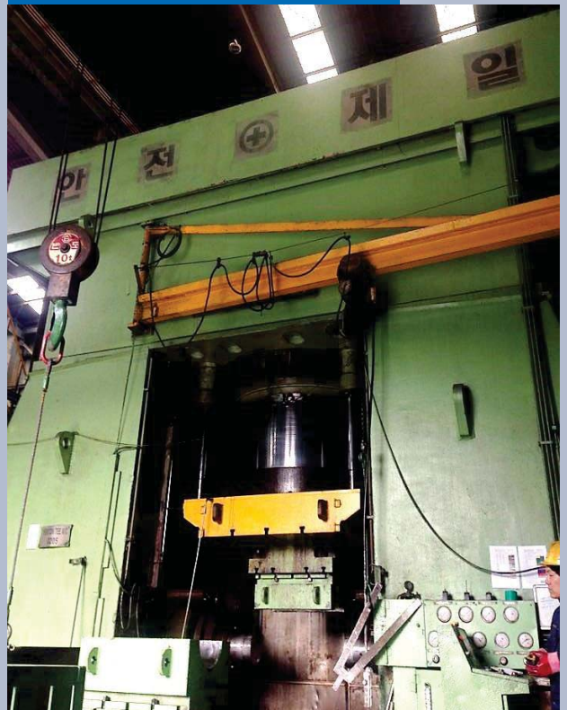
Tee Bulging Press 15,000 Ton
